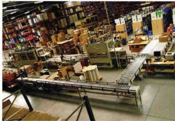
Influx a fourni à Wesco (équipement pour l'enfance BtoB et BtoC) un WCS intégrant des fonctionnalités WMS, pour gérer une zone de préparation de commandes à gares pour des produits à forte rotation : calcul du nombre de colis nécessaires, ordre de lancement des colis pour que les gares soient toujours occupées, gestion des emplacements et du réassort, inventaire des produits sortant de cette zone...
